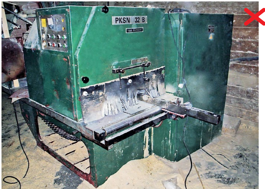
Fotografia č. 8: Drevoobrábací stroj prevádzkovaný bez odsávacieho zariadenia
