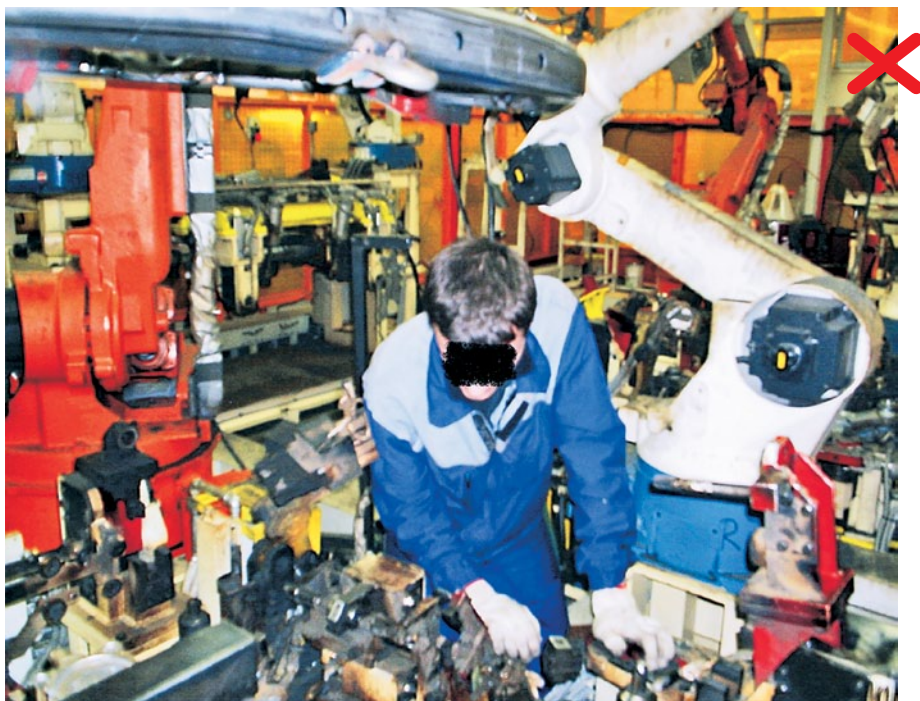
Fotografia č. 6: Údržba vykonávaná počas chodu linky priamo v zóne nebezpečenstva
