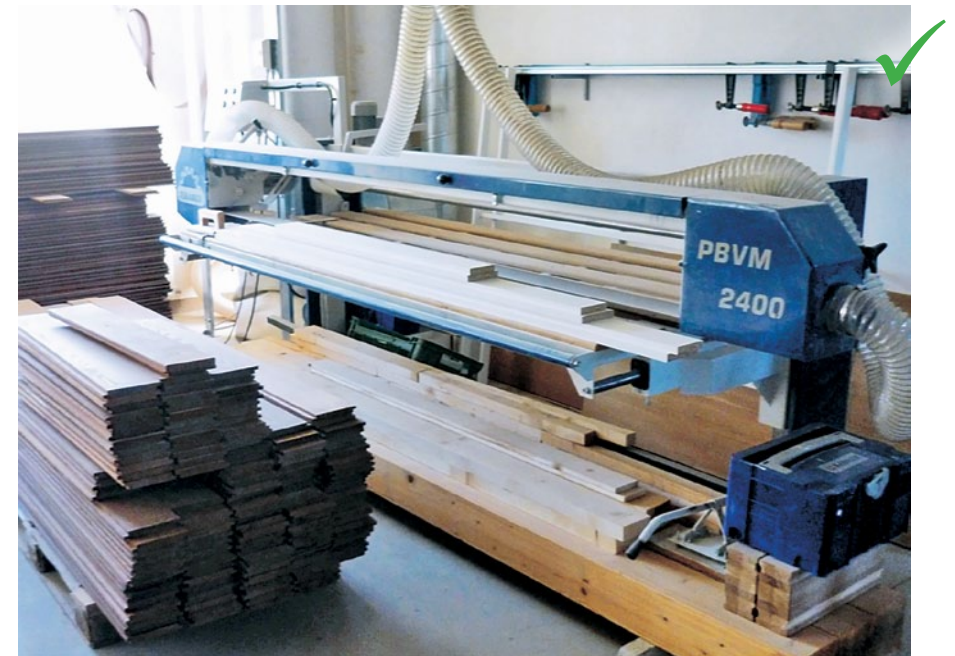
Fotografia č. 9 Príklad drevoobrábacieho stroja s odsávacím zariadením
