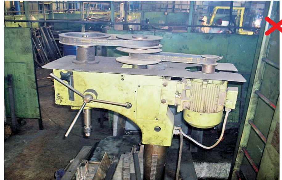
Fotografia č. 1: Stojanová vŕtačka bez krytu remeňových prevodov
