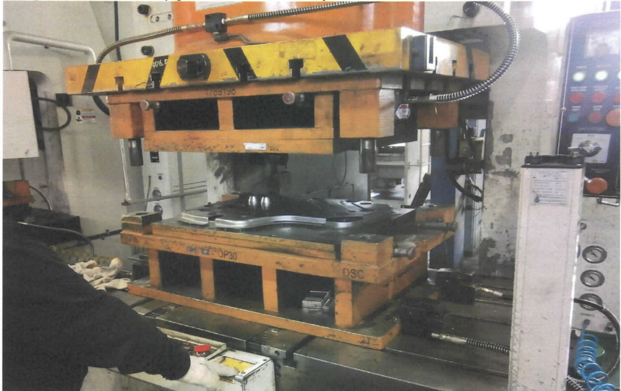
Fotografia č. 5.: Pracovný priestor lisu s ochranným zariadením.
