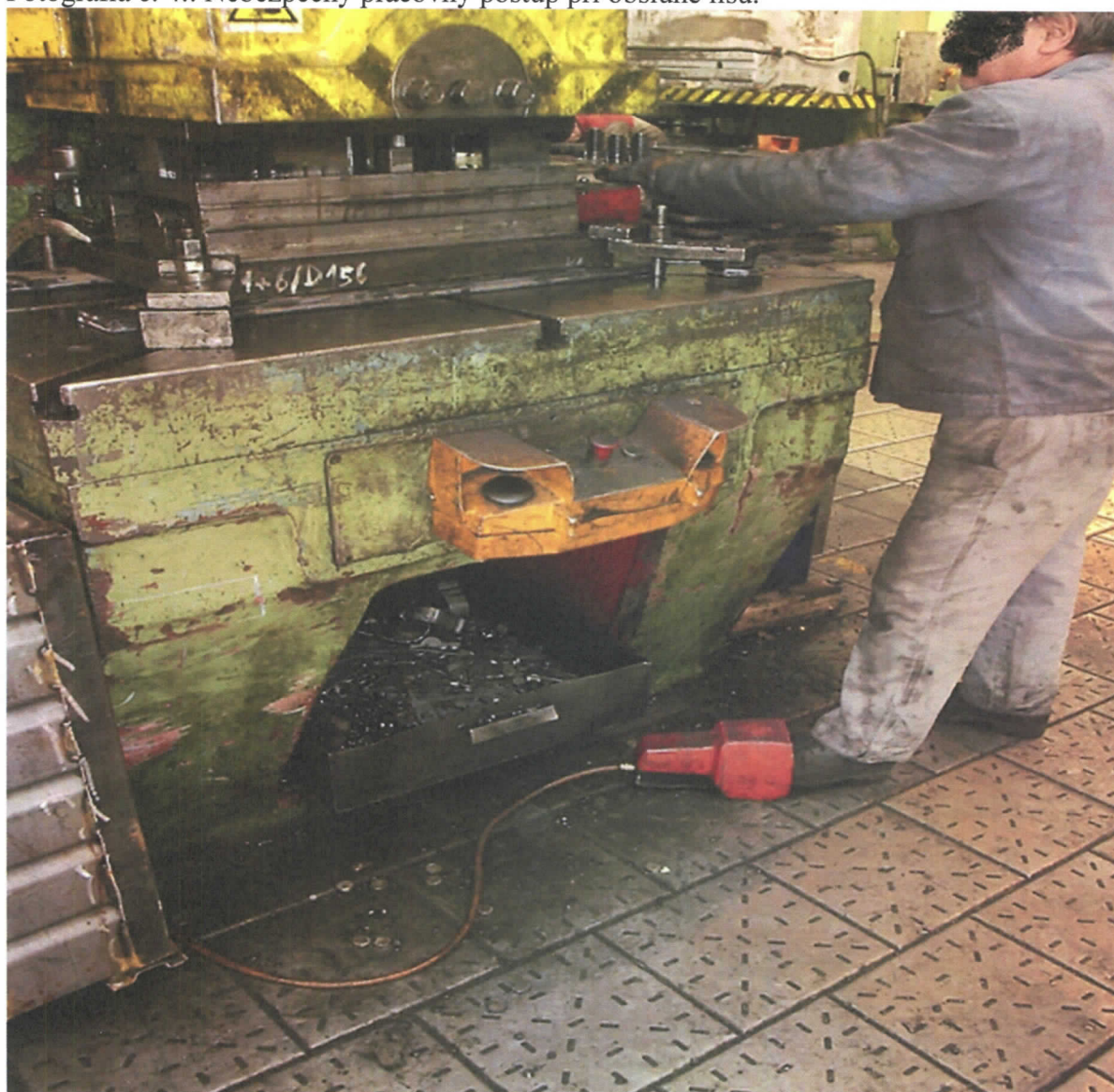
Fotografia č. 4.: Nebezpečný pracovný postup pri obsluhu lisu.
