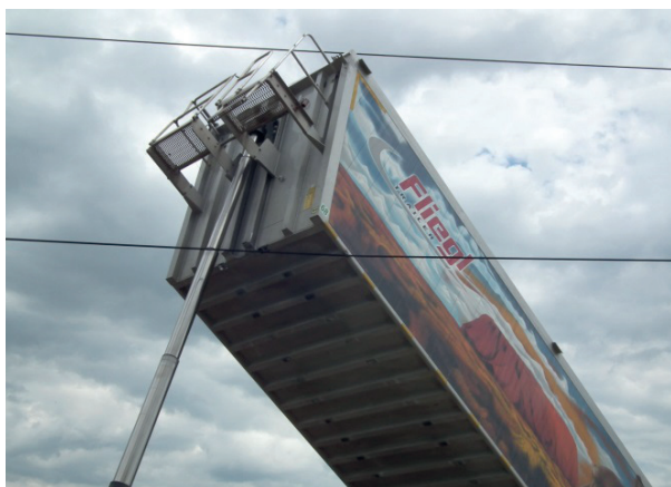
Kontakt s 22 kV vedením
